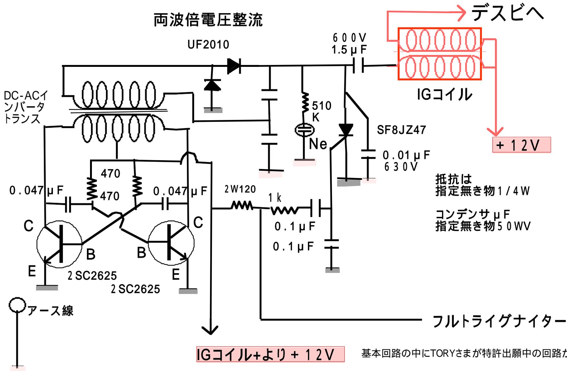
トリガー回路をECU対応に変えるとIGコイル外付けECU付きの車でもつかえます。
